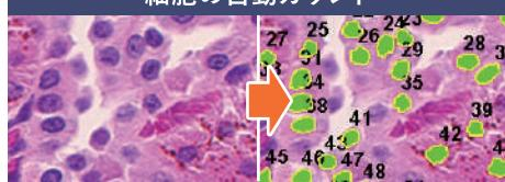
計測対象の色や明るさを指定して、自動でカウント・大きさを計測します。
